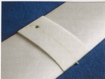
Slika 22. Sredina krila z zgornjim delom kabine in sedežem vijaka
