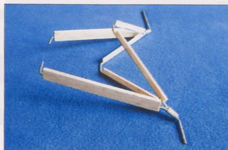
Slika 30. Podvozje s prilepljenimi letvicami
