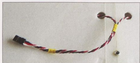
Slika 53. Kabla združimo in prilotamo priključke konektorja.
