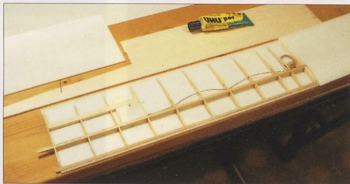
Slika 12. Pritrjeno krilo z balzovo deščico kot vodilom
