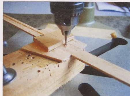
Slika 29. Rezkanje utora v letvico
