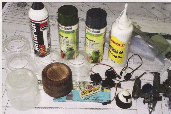
Lepila, barve, plastične zasteklitve kabine, lesen kalup in pokrovi motorja iz plastenke, servomehanizmi, kapa propelerja, motor
