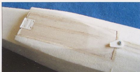
Slika 45. Oblikovan in zavarovan pokrov jaška akumulatorja
