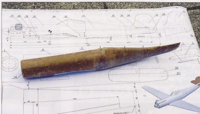
Trup je oblečen v rjav papir in prevlečen s tanko plastjo epoksidnega lepila.
