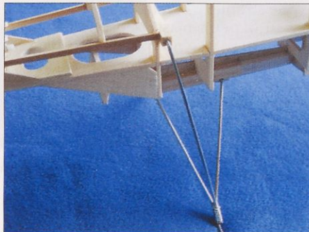
Slika 26. Deli podvozja so nameščeni na trup.
