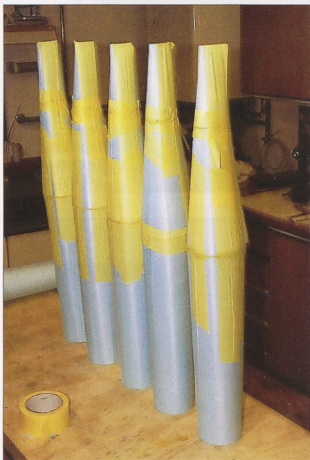
S poliuretanskim lepilom E-20 kose zlepimo in jih fiksiramo z lepilnim trakom.
