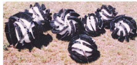
Slika 3 • Splakovalne kroglice (Göttinger Kugel) različnih premerov
