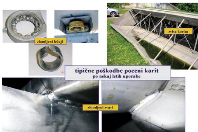
Slika 24 • Nekaj tipičnih okvar neakovostnih korit
