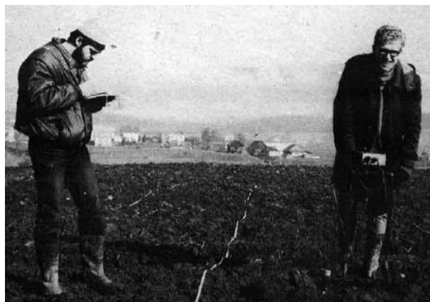
Slika 3. Benečija pri Trebnjem (1988). Andrew Waters (desno) izvaja meritve z merilnikom navidezne upornosti Geoscan RM4 (foto: D. Breščak).
