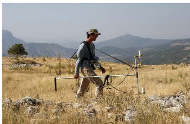
Slika 5. Sagalassos – Turčija (julij 2009). Izvajanje georadarskih meritev z georadarjem GSSI 3000 in 200 MHz anteno s prenosno kontrolno enoto (zgoraj) in magnetnih meritev s cezijevim magnetometrom na optično črpanje Geometrics G-858 (spodaj) (foto: T. Šoba in U. Kirn).
