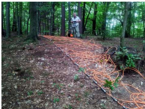
Slika 6. Prva izvedba meritev upornosti za 2D geoelektrično tomografijo (ERT) z instrumentom ARES na gomilnem grobišču Poštela (foto: I. Medarić, 2015).
