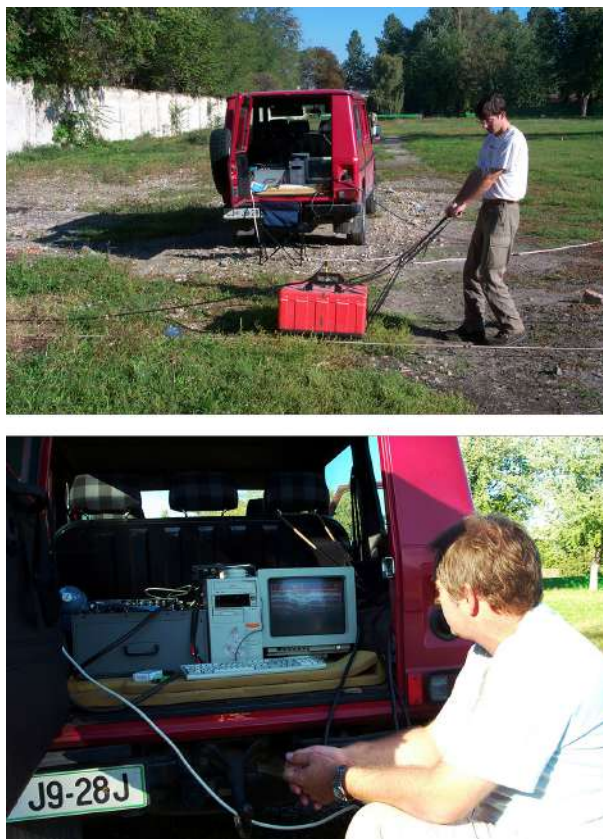
Slika 4. Osijek, Hrvaška (2001). Georadarske meritve s starejšim modelom georadarja GSSI SIR-3 z 200 MHz anteno, brez prenosne kontrolne enote (foto: D. Snoj).
