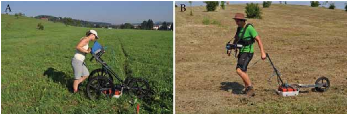
Sl. 13: Panorama. Meritve z georadarjem GSSI SIR3000 v kombinaciji z 400 MHz anteno smo na relativno ravnih površinah izvajali s pomočjo vozička (A), na terasah in drugih neravnih delih pa "ročno" (B).
