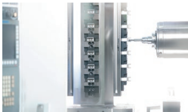
» Vpenjalni primeži KONTEC KMS podjetja Schunk so namenjeni vpenjanju večjega števila obdelovancev ter omogočajo uporabo številnih različnih za serijsko proizvodnjo. Sistem se hitro in enostavno namesti in nastavi. Vir: Schunk
