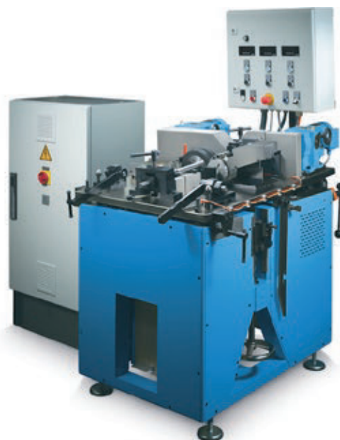
» Novi stroj PrecisionGrind PG6 za hitro in natančno končno obdelavo konic igel. Vir: Jouhsen-bündgens
