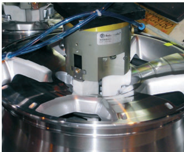
» Slika 1: Tričeljustno prijemalo za prijemanje okroglih delov, opremljeno s plastičnimi prsti, ki preprečujejo raze na delu.
