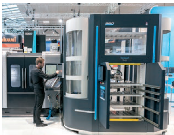
» Operater na stroju na palete vpne obdelovanca, palete vstavi v celico, programira rezkalni stroj in zažene program, sistem pa nato dela avtomatizirano. (Fotografije: HURCO in BMO)
