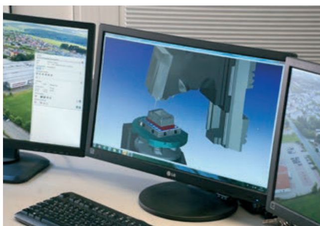
» Slika 2: Pri KNARR-u pripravijo NC-programe na osnovi 3D-modelov CAD v paketu Hypermill (Openmind). Rezkarje krožnega izseka podpira modul Maxx Machining.
