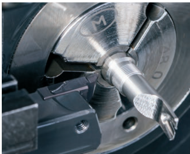
» Struženje zunanega navoja M7 × 0,5 s sistemom S274
