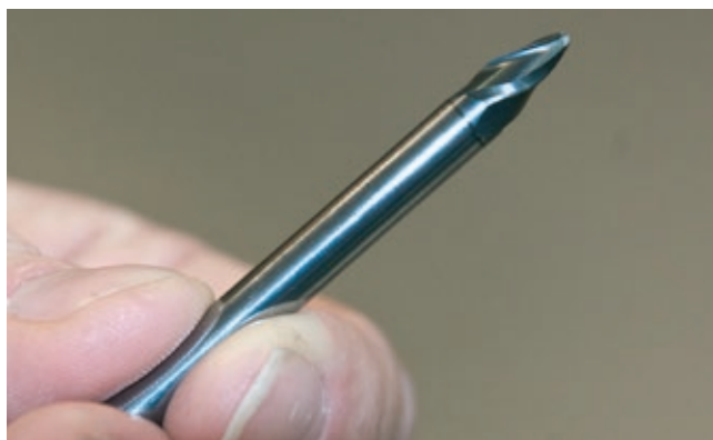
» Slika 6: Rezkarji krožnega izseka Franken so na voljo v sodčkasti, kapljičasti, stožčasti in lečasti obliki. Na sliki je rezkar stožčaste oblike premera 6 mm.
