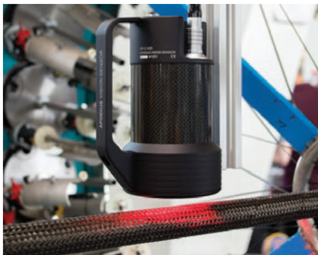
» Spremljanje orientacije karbonskih vlaken neposredno med proizvodnim procesom. Vir: Hexagon
