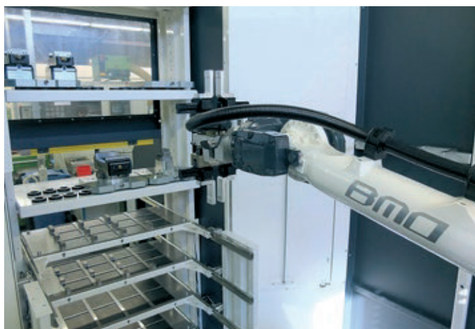
» Operater na stroju na palete vpne obdelovanca, palete vstavi v celico, programira rezkalni stroj in zažene program, sistem pa nato dela avtomatizirano. (Fotografije: HURCO in BMO)
