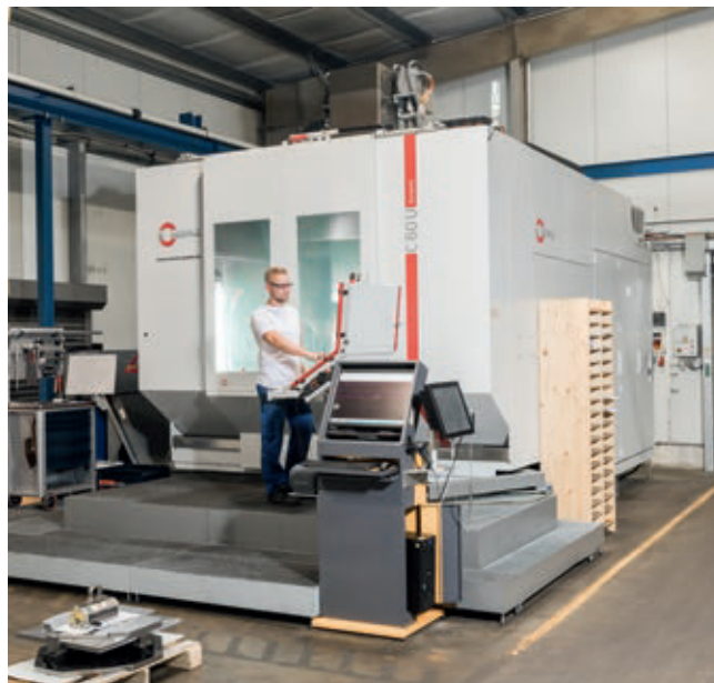
» 5-osni visoko zmogljiv CNC-obdelovalni center C 60 U za obdelavo velikih surovcev. Vir: Hermle
