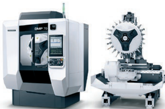
» Tlorisna površina stroja DMP 70 meri samo 4,2 m 2 , kljub temu pa je delovno območje velikosti 700 x 420 x 380 mm.
