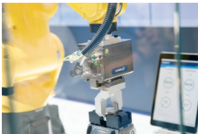
» Pametne vpenjalne naprave in prijateljski sistemi podjetja Schunk lahko merijo, prepoznajo in spremljajo obdelovance in proizvodni proces v realnem času. Vir: Schunk
