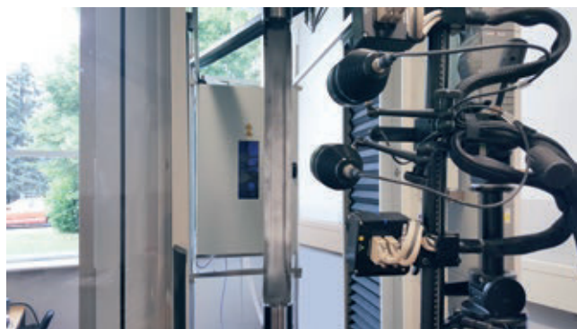
» Strešni lok med obremenitvenim testiranjem. Merilni sistem ARAMIS spremlja testiranje in omogoča pridobivanje informacij o celotnem območju komponente ter podatke o določenih merilnih točkah. Vir: TU Chemnitz
