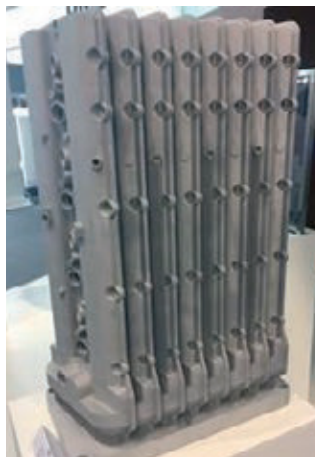
» Osem pokrovov Bugattijevega motorja W16 hkrati izdelanih na stroju SLM 800 in predstavljenih na sejmu Formnext 2018. Vir: SLM Solutions Group AG
