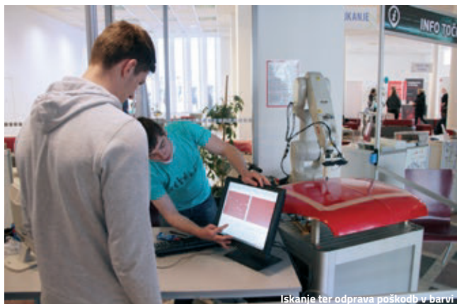
Iskanje ter odprava poškodb v barvi
