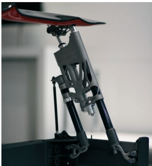
» Nosilec zadnjega krila, izdelan s postopkom aditivne proizvodnje na stroju SLM 500. Vir: SLM Solutions Group AG
