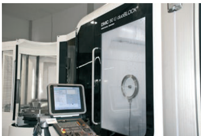
» Slika 5: Obvezno pet osi: rezkarji krožnega izseka pri KNARR-u so hlajeni samo s stisnjenim zrakom, ki obenem tudi odvaja odrezke.
