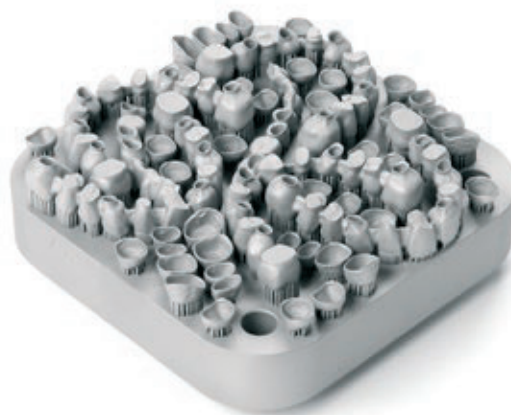
» Zobne krone in mostički izdelani s postopkom aditivne proizvodnje. Vir: SLM Solutions Group AG
