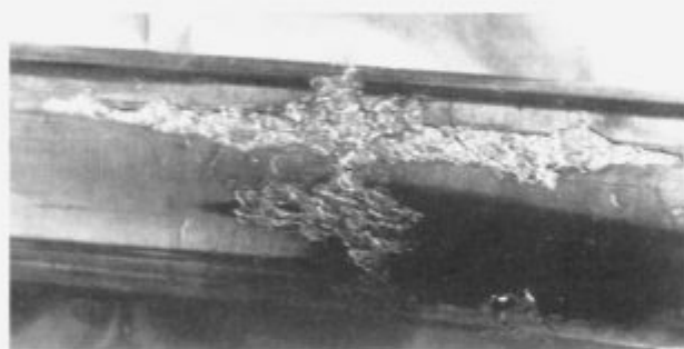
Slika 7: Luščenje površine valja iz jekla Utop Mo 6 Figure 7: Spalling of roll surface of steel Utop Mo 6
