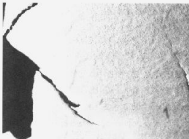
Slika 4: Mikrorazpoka v mikrostrukturi jekla BRM 2, pov. 100 x
