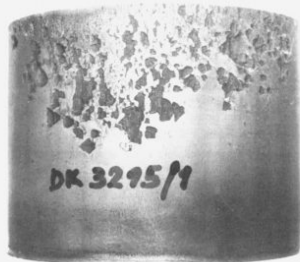
Slika 10: Drobljenje površine valja iz jekla BRM 2 Figure 10: Crushing of roll surface of steel BRM 2
