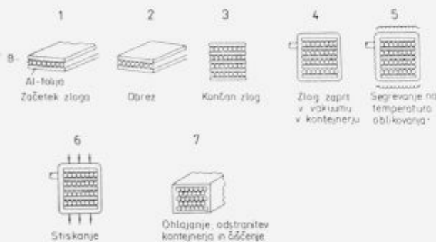
Slika 8 Shema izdelave kompozita Al-B 1 Figure 8 Schematic of Al-B composite fabrication 1
