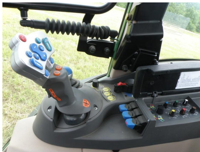
Profi vozno-krmilna ročica za upravljanje različnih funkcij. (foto: D. Vrhovnik)
