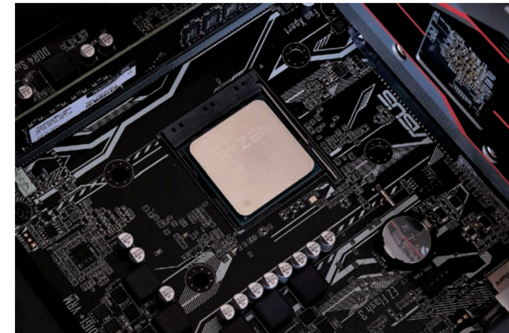
△ V primerjavi z Intelom pri AMDju dlje časa vztrajajo z istim podnožjem. Aktualni AM4 sprejme vse tri generacije procesorjev Ryzen – še vedno pa moramo biti pozorni na vezni nabor matične plošče.
