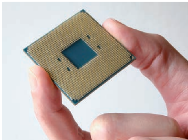
△ AMDjevi procesorji imajo na spodnji strani nožice in zahtevajo nekoliko več previdnosti pri vgradnji.
