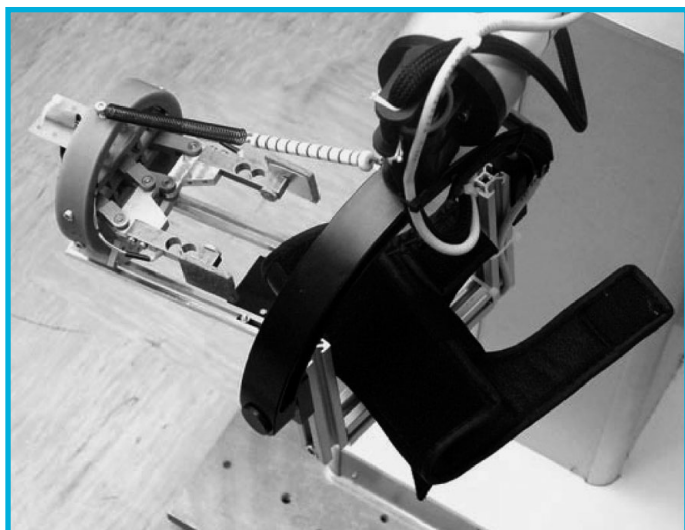
Slika 2: Modul za prijemanje: roka je vpeta v zapestju z opornico na gimbal. Gimbal je pasivna naprava z dvema prostostnima stopnjama, ki je pritrjena na vrh robota, na gimbal pa je pritrjen modul za prijemanje. Na vsaki od ročk se meri sila, ki jo oseba izvaja s prsti.
