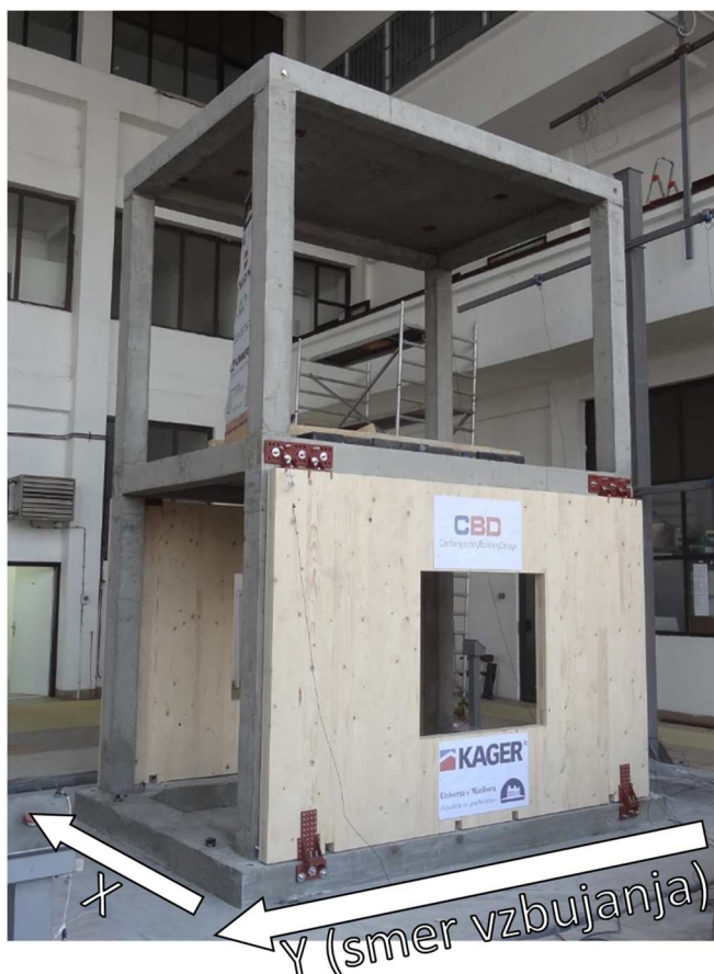
Slika 6.16: Utrjen AB okvir – utrjena je bila samo spodnja etaža.
