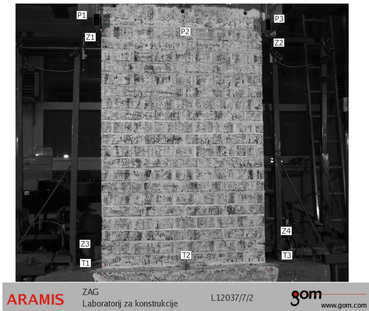
Slika B.2: Pozicije točk za fotografsko spremljanje pomikov neutrjenega opečnega zidu Figure B.2: Positions of points for the photogrammetric displacement measuring of the unreinforced wall
