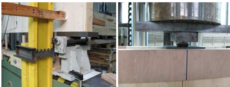
Slika 4.3: Ena od spodnjih dveh drsnih vertikalnih vogalnih podpor stene (levo) in kroglasti ležaj za vnos vertikalne sile na vrhu (desno)
