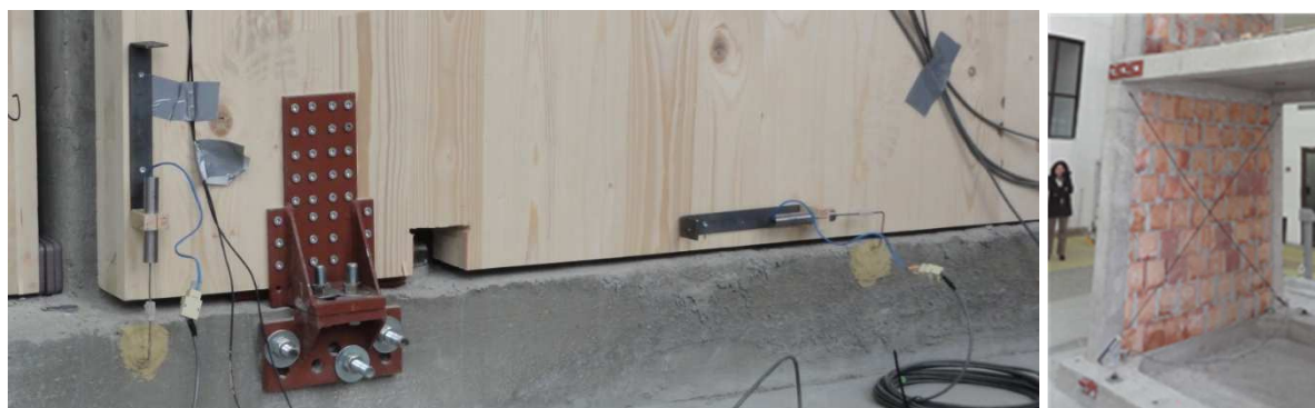
Slika 6.14: Poziciji induktivnih merilcev V-F1-DL in H-F1-D (levo) ter diagonal D1 in D2 (desno)
