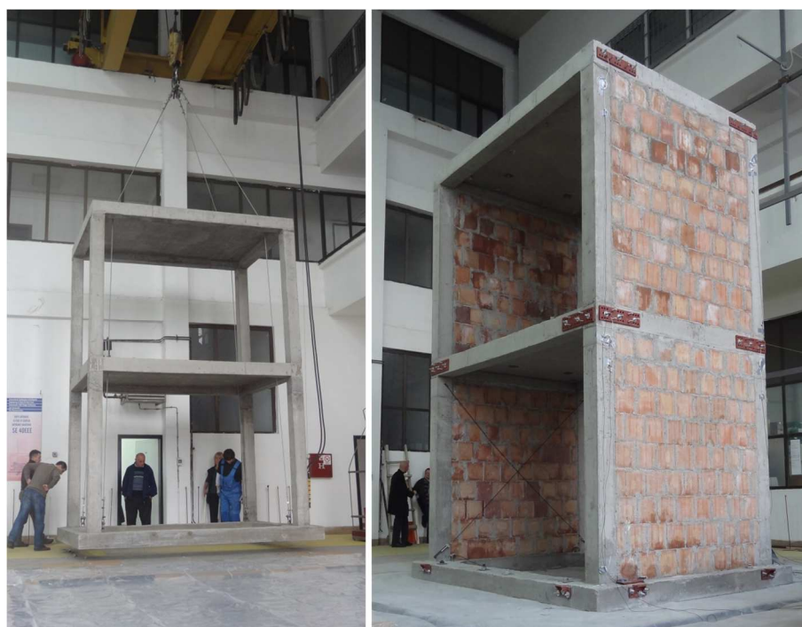
Slika 6.1: Armiranobetonski okvir med premikom na potresno mizo (levo) in AB okvir z opečnim polnilom (desno)
