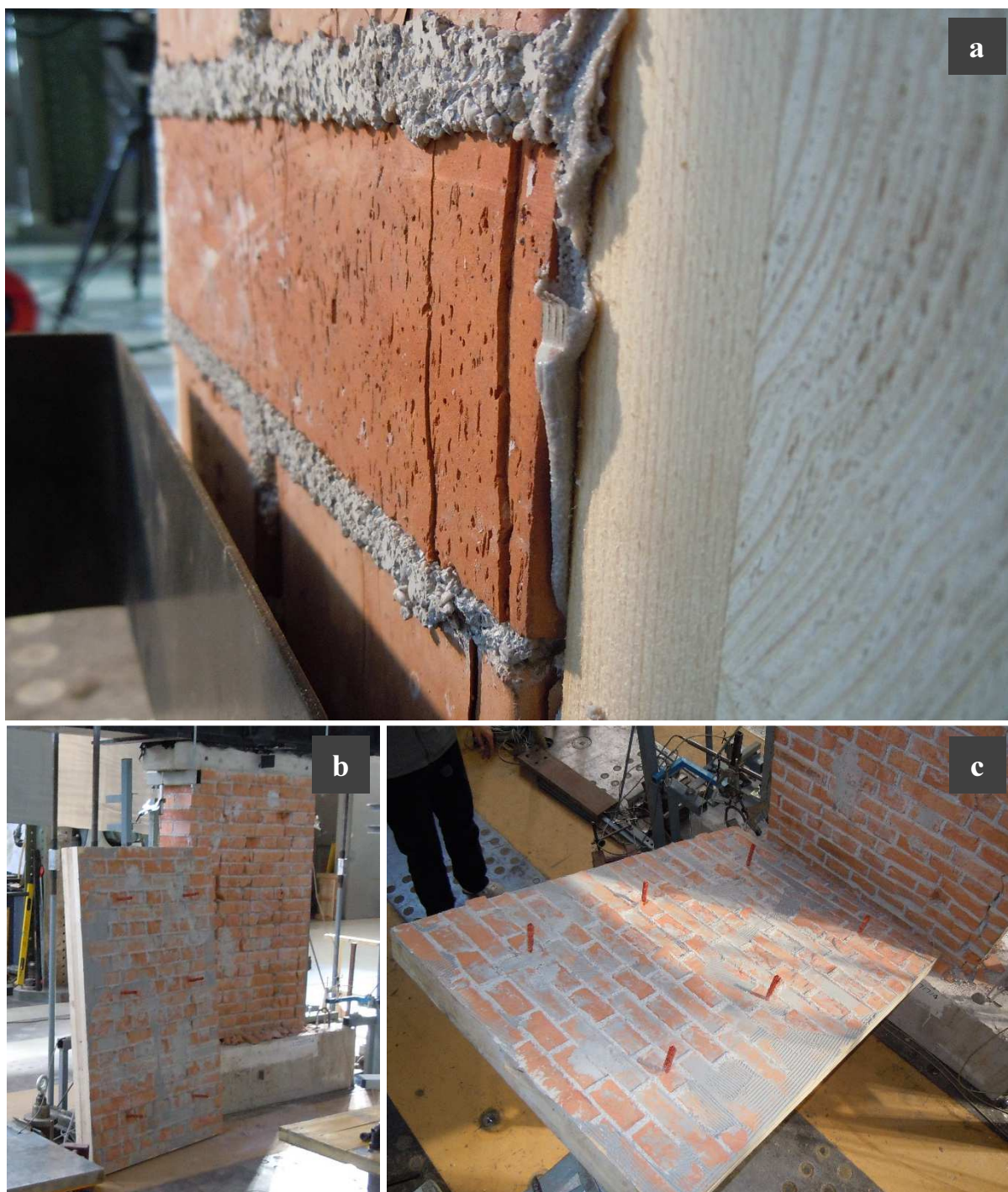
Slika 5.21: Nastanek prvih strižnih razpok v zidovju tik ob lepljenem stiku (a) ter popolna natezna porušitev opeke po celotni površini zidu (b in c)
