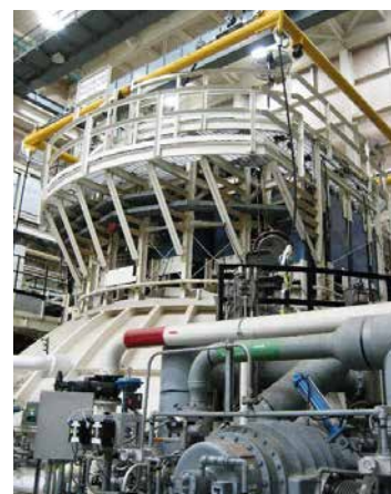
» Slika 5. Kupola komore je snemljiva, tako da je mogoče z vrha vstaviti večje predmete za preizkušanje. Rumeni žerjav dvigne in premakne kupolo na ploščad levo od te slike.
