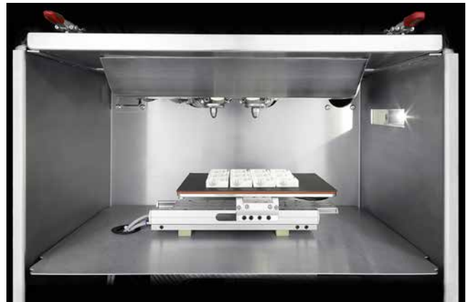
» Slika 5: Primer aplikacije: Freeformer proizvaja ohišja z dvanajstimi vtičnicami iz ABS. Ohišja bodo rezervni del za stroje za brizganje Allrounder.
