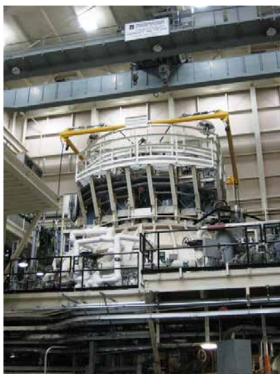
» Slika 1. Komora B je široka 10,7 m in visoka 13,1 m, tako da je manjša od dveh komor za nadzorovano okolje v zgradbi 32 središča NASA JSC.
