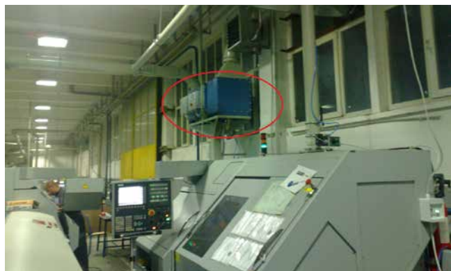
» Slika 3: Primer uporabe elektrostatičnega filtra za odsesavanje in izločevanje oljnih par oziroma emulzijske megle pri obdelovalnih strojih
