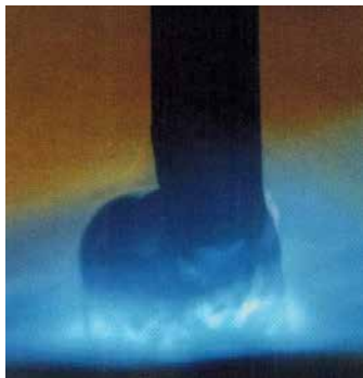
» Slika 1: Odtaljevanje in formiranje grobe kapljice na koncu varilne žice med grobo kapljičastim varjenjem MAG.
