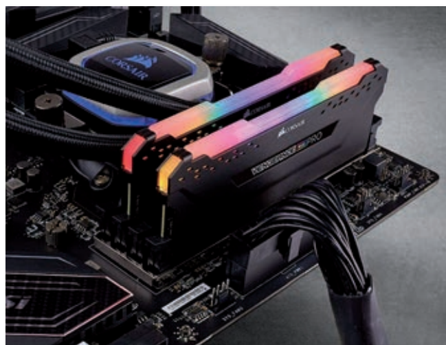
△ Pomnilniški moduli se pogosto prodajajo v parih, saj tako izkoristimo dodatno hitrost dveh kanalov. Moramo pa paziti, da ju vgradimo v pravilni dve reži na matični plošči, kar preverimo v navodilih plošče.
