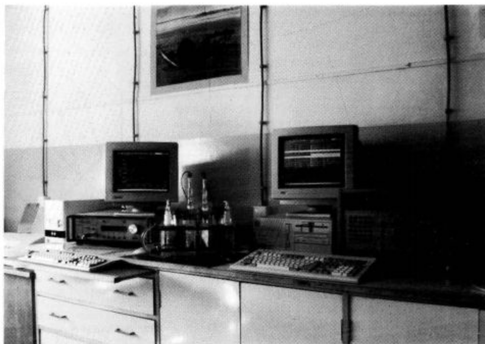
Slika 2: Sklop aparatur za merjenje permeabilnosti kovin za vodik
