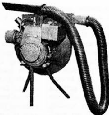
Sl. 34 Kompresor za izplihovanje čebel in kozlica za naklado
