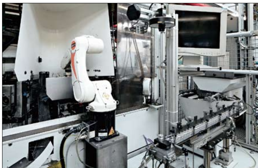
Slika 3. Popolnoma avtomatizirana obdelava pokrovov za delovne valje DSNU z robotsko strego in prepoznavanjem položaja s kamero
