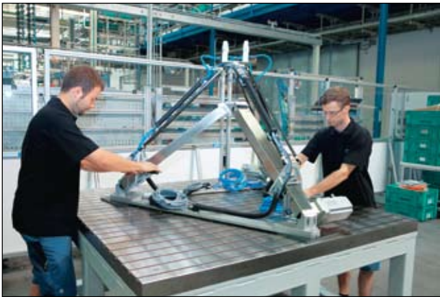
Slika 6. Tropodni sistem za rokovanje z materialom iz standardnih sestavnih delov kot pripravljena rešitev za uporabo (foto: Festo)
