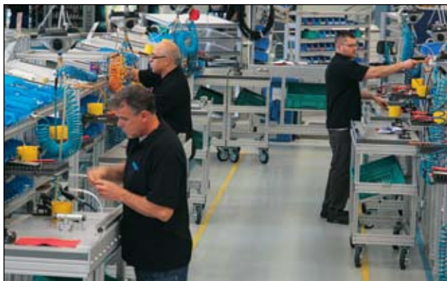
Slika 4. Sestavljanje električnih in pnevmatičnih pogonov po načelu toka materiala kos po kos (foto: Festo)
