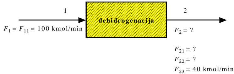
Pretok etana v reaktor znaša 100 kmol/min, pretok vodika na iztoku je 40 kmol/min.
