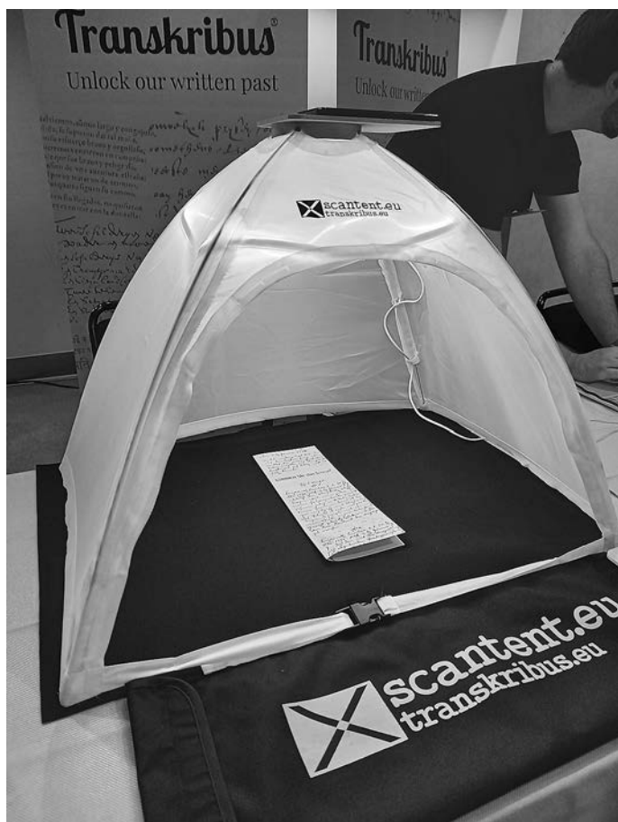
Pripomoček, ki omogoča digitizacijo arhivskega gradiva s pomočjo pametnega telefona – nekakšen fotografski šotorček z vgrajeno lučko (Foto: Mojca Horvat)
