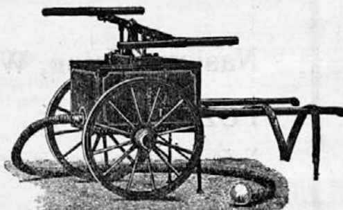
Dvokolna brizgalnica, podvojeno brizgajoča 180 — 200 2 /min.
