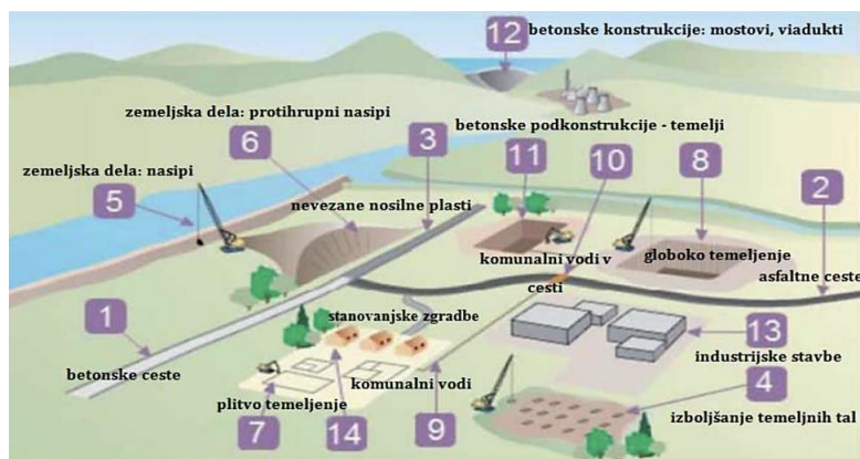
Slika 3: možne uporabe recikliranih agregatov v gradbeništvu
