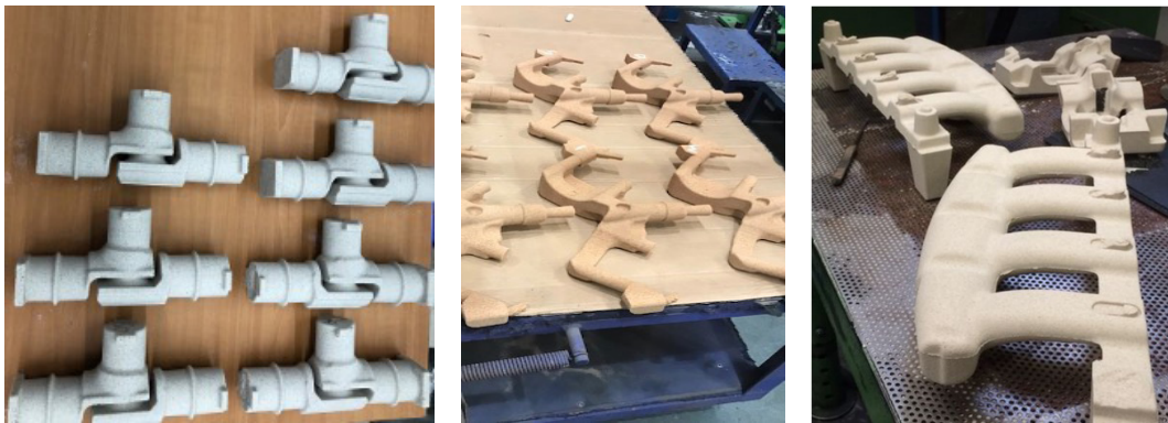
Slika 12. Primeri uporabe anorgansko vezanih jeder za neželezne ulitke
