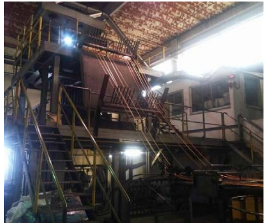
Slika 2. Vlečenje žice proti navijalu
