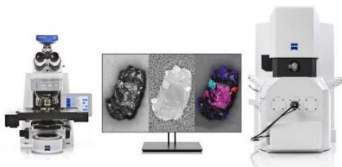
Slika 5. Korelativna analiza tehnične čistosti
