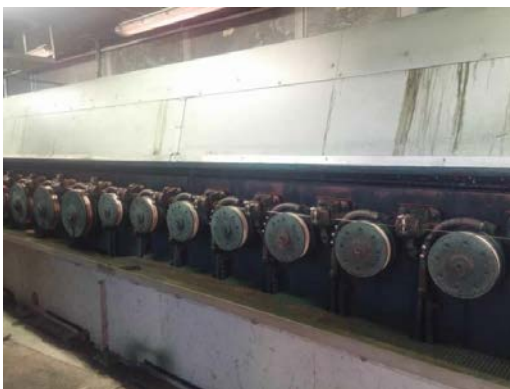
Slika 4. Stroji za neprekinjeno vlečenje žice
