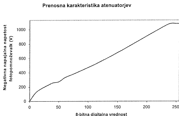
Slika 19. Prevajalna funkcija atenuatorskih modulov.
