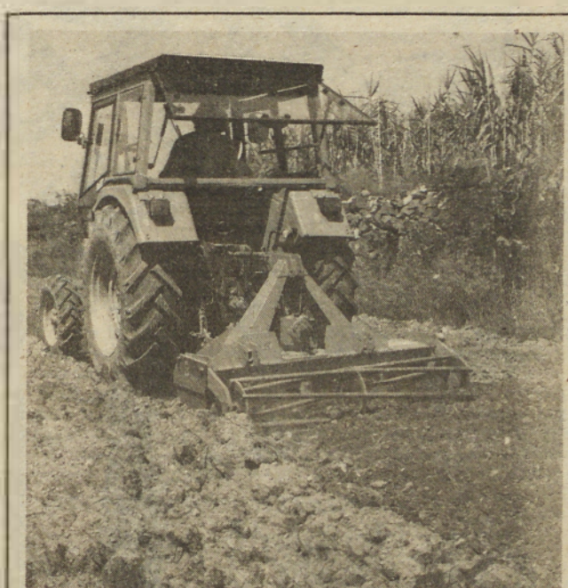
VRTAVKASTA BRANA CVB CIMOS 1500 teža: 460 kg dolžina: 0,915 m širina: 1,612 m delovna širina: 1,5 m max. delovna globina: 0,20 m pogonska moč: 22 — 30 kW število prestav: 1
