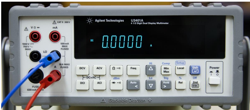
Slika 3: Ampermeter na 5 A merilnem območju
