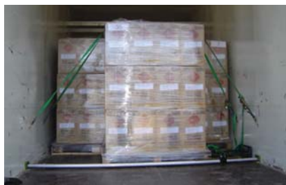
Slika 12. Pravilno naložen (pritrjen) in označen tovor. Pravilne in čitljive oznake za nevarnost so še kako pomembne za določanje vrste nevarnosti ob nesreči
