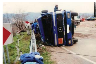
Slika 15. Pravilno napisana in pravilno nameščena oznaka na vozilu, ki prevaža nevarne snovi, je v primeru prometne nesreče odločilna za sprejetje prvih nujnih ukrepov (izbira smeri prihoda na kraj nesreče, izbira pravilne opreme, velikost območja zavarovanja kraja,...) za sanacijo prometne nesreče
