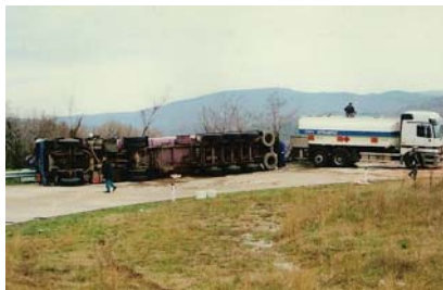
Slika 13. Primer nesreče vozila, ki prevaža nevarno snov. Oznake za nevarnost niso vidne zaradi položaja vozila
