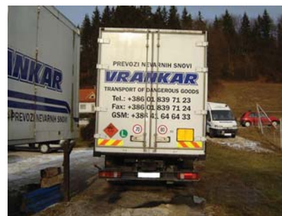
Slika 14. Zakonsko pravilno označeno (z oranžno tablo in tablo, ki pove, kakšno lastnost (nevarnost) ima tovor) vozilo za prevoz nevarnih snovi
