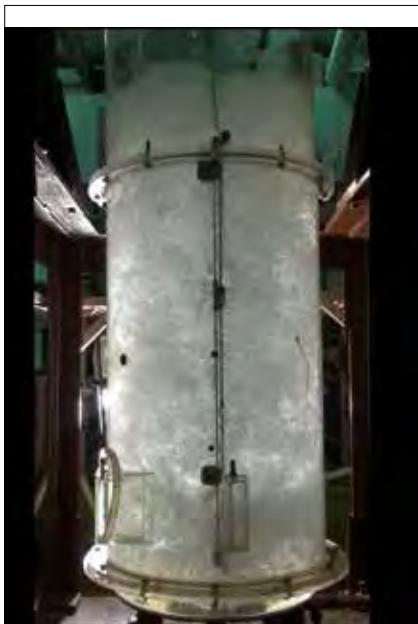
**Slika 17.** Dispergiranje zraka na mešalni napravi pri 178 vrt/min in pretoku zraka  $28,3 \text{ m}^3/\text{h}$
