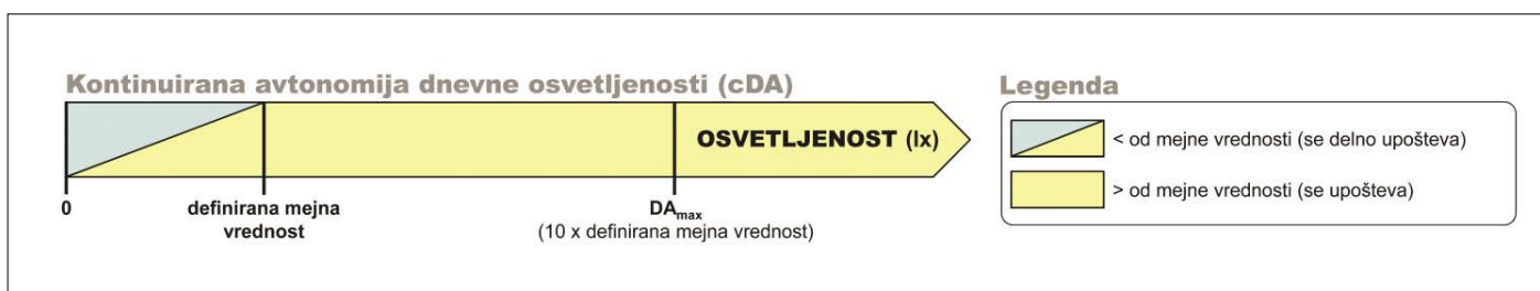
Slika 2 • Kontinuirana avtonomija dnevne osvetljenosti
