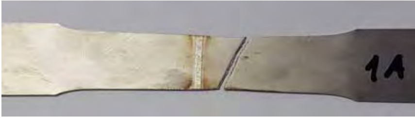
Slika 5 : Epruveta nateznega preizkusa sočelnega vara
