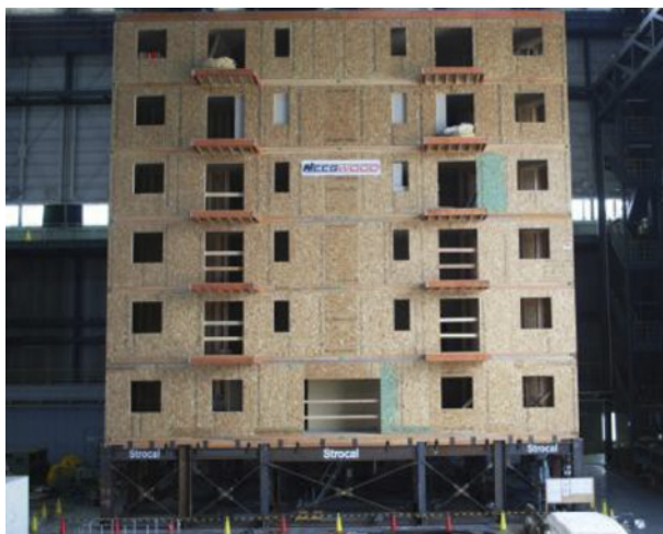
Slika 8. Testiranje lesene zgradbe s simuliranjem potresa (Cheung, 2010).
