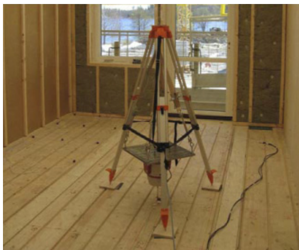
Slika 2. Testiranje vibracij tal (Jarneo in sod., 2010)
