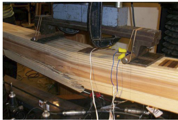
Slika 5. Upogibni test lepljenega nosilca, ojačanega z zgoščenim lesom (Anshari in sod., 2010).
