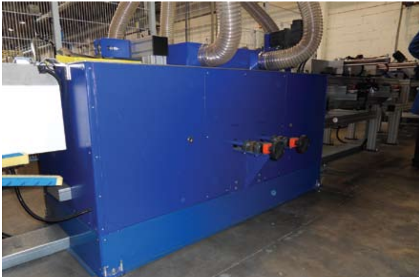
Protihrupna zaščita iz kosmita st 100 je v glavnem pripomogla k znižanju ravni hrupa ob delovni mizi s 85 dBA na 77 dBA.
