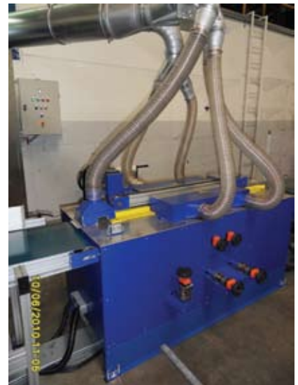
Dodatna postavitev nape s kosmit oblogo st 100, deb. 5 cm, je največ pripomogla k zmanjšanju hrupa nad frezalnikom s 84 dBA na 77 dBA.
