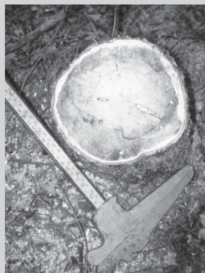
□ Slika 7. Smreka ( Picea abies ): (a) rdeča trohnoaba na lokaciji svetle jedrovine; (b) rdeča trohnoaba v razvitem stadiju, ko je začela prodirati v beljavo (foto Miran Čas)
