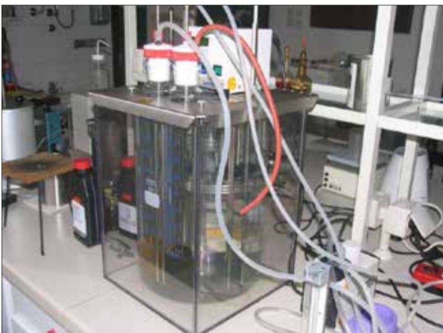
Slika 2. Aparatura za izvajanje testa penjenja, proizvajalec Petrotest
