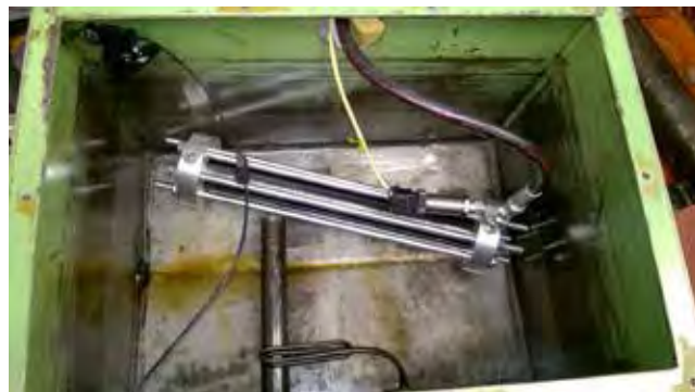
Slika 2 : Hidravlični valj s kompozitno cevjo v zaščitni komori pred visokotlačnim porušitvenim testom
