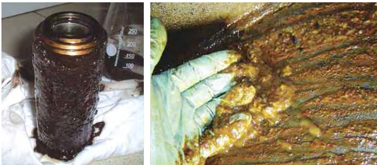
Slika 1 : Popolnoma zamašen – blokiran – filtrski vložek hidravličnega sistema parne turbine –levo (slika last Thomassen Turbines) ter gošča na dnu rezervoarja – desno (slika last Clarus Technologies)
