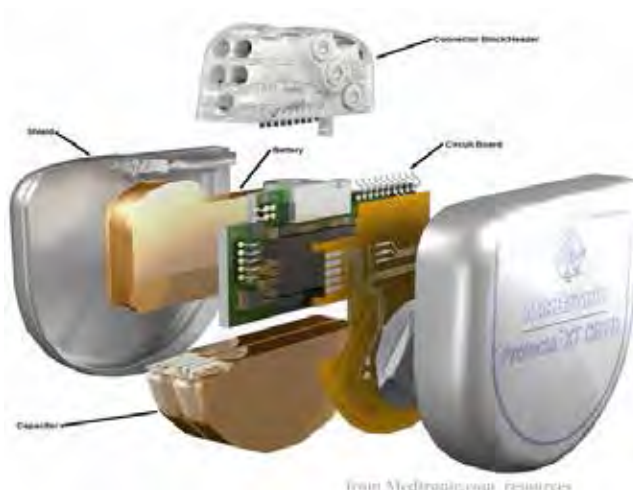
Slika 2 : Tipični dinamični vsadek, vstavljen v zaščitno antimikrobno prevleko – pogled na razstavljen dinamični vsadek ICD
