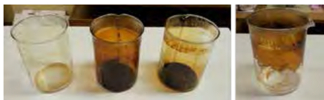
Slika 6 : Tvorjenje netopnih lakastih produktov na stenah čaše in usedlin na dnu
