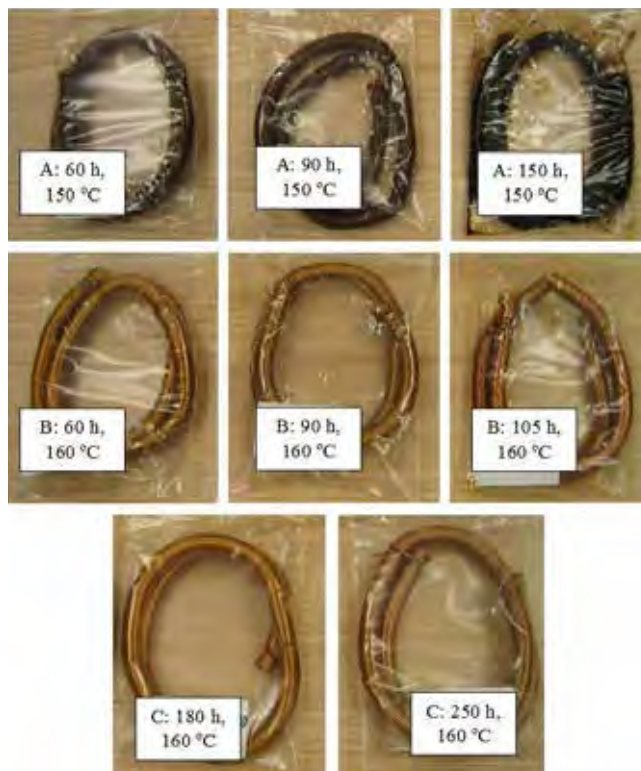
Slika 7 : Nagnjenost k tvorbi netopnih lakastih produktov na bakreni žici
