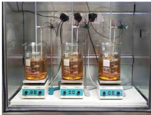
Slika 4: Termični test za pospešeno staranje hidravlične tekočine
