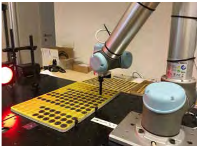
Slika 5 : Pobiranje merjenca s palete
