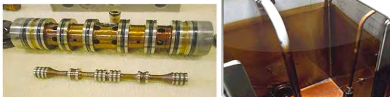
Slika 2 : Lakasti produkti na drsniku krmilnega ventila (levo) [7] in v notranjosti rezervoarja (desno) [8]
