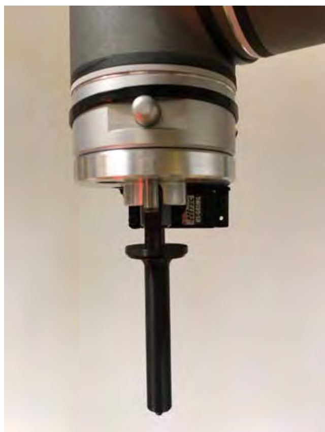
Slika 3 : Posebej zasnovano prijemalo za natikanje in iztikanje merjencev
