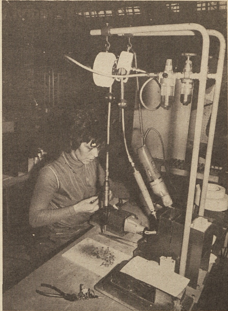
Iz Industrije telekomunikacij — TOZD ERO: Nada Kolar dela na tekočem traku za montiranje vrtnih strojev VS 110A4 — končna sestava strojev.
