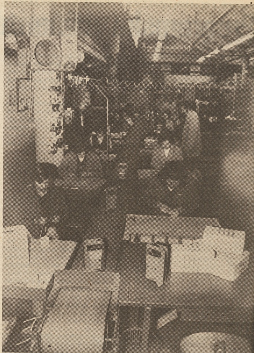
Lahko montažni trak za polnilnike Pobi, Korektor in Poli.
