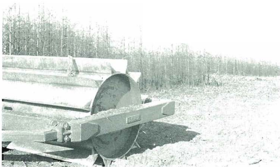
Fleco sekalni valj (15 ton) je namenjen za uničevanje zelene vegetacije na površinah, ki jih pripravljamo za umetno obnovo. Foto M. Hočevnar
