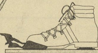
Tekaška smučka ima drugačno vez kot alpska. Sprednji del podplata je nataknen na tri čepke in streme ga tišči k smučki. Pri hoji pa lahko brez težave zadnji del noge dvigamo s smučke.
