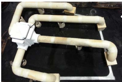
Slika 15a. Dovodni sistem z nameščeno filtrsko škatlo izliva HOLLTEX
