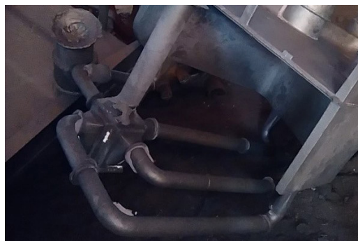
Slika 15b. Ulitek z izlivkom HOLLTEX – peskan
