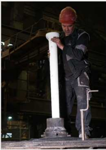
Slika 6a. Vstavljanje izlivka HOLLOTEX v sestavljeno formo
