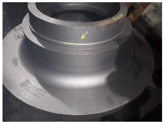
Slika 13d. Ulitek po pregledu MPI
