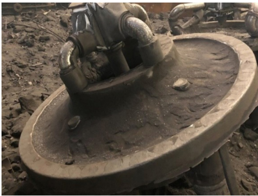
Slika 13c. Litje z izlivkom HOLLOTEX
