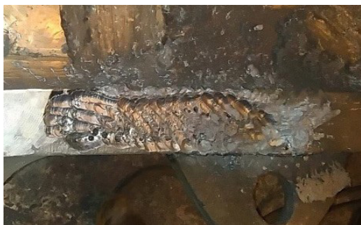
Slika 14a. Značilne napake – plinske luknjice na zgornji površini
