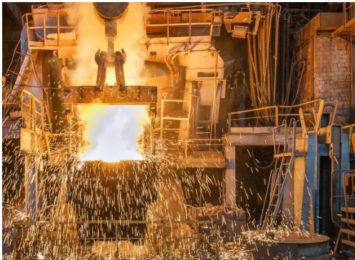
Slika 2c. Izpuščanje povzroči zajem zraka in nastanek bifilmov
