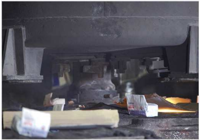
Slika 6b. Litje kovine skozi izlivek HOLLOTEX
