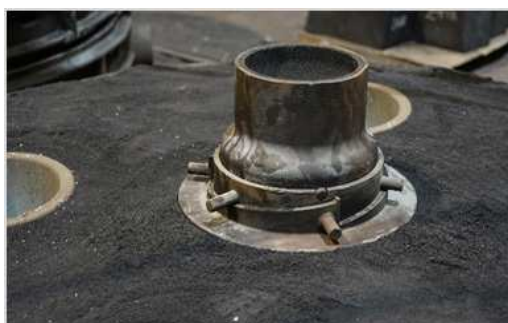
Slika 5b. Bajonetni dvižni sistem na vrhu forme
