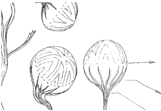
Slika 3a. Sledi mehurčkov in bifilma na zadnji strani
