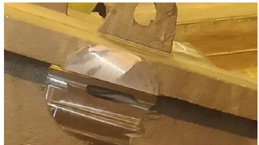
Slika 16b. Brez vključkov peska ali plinskih mehurčkov
