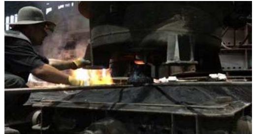
Slika 8b. Lonec v položaju. Pripravljen je za sukanje bajoneta z jeklenimi palicami in povezovanje izlivka s šobo
