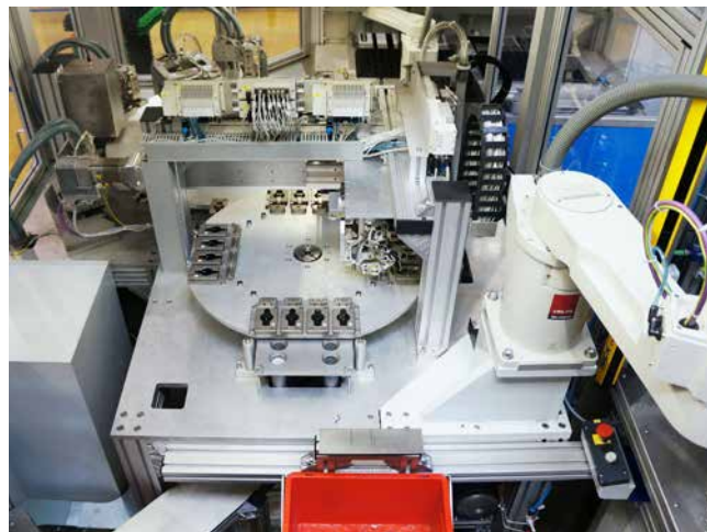
» Robot SCARA povezuje brizgalko s pregledovalno postajo.
