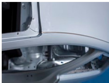
» Slika 3: Audi A3 2012 – detajl lasersko spajkanega spoja strehe in stranice avtomobila
