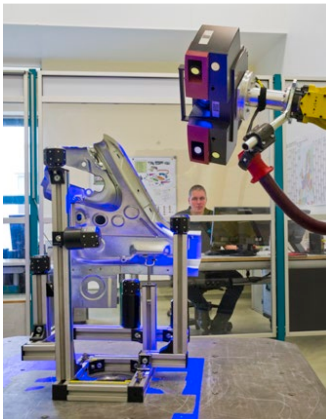
» Slika 4: Prva avtomatizirana rešitev pri GEDII: Merilna celica po meri z integrirano opremo GOM
