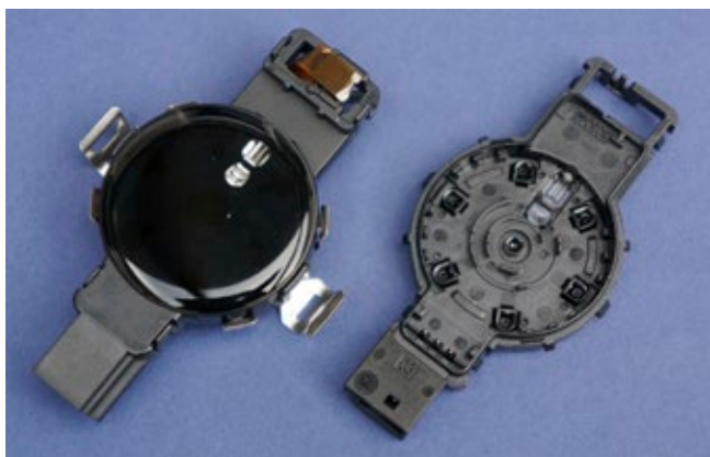
» Zaznavalo za dež, svetlobo in vlago je štirikomponentni izdelek: dve leči iz kristalno prozornega polikarbonata in sedem leč iz rdečega polikarbonata ter ohišje iz črnega polikarbonata. Tri kovinske sponke za kontakte, ki so nameščene v orodje in nato nabrizgane, pa so četrta komponenta.
