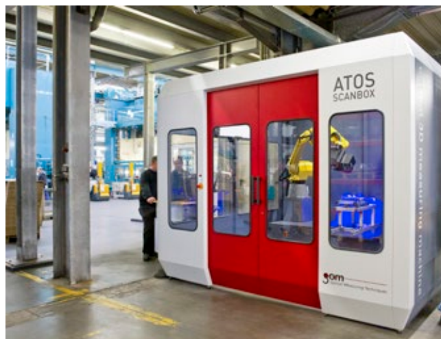
» Slika 5: Standardizirani ATOS ScanBox ima vse elemente, potrebne za popolnoma samodejno 3D-digitalizacijo in kontrolo. Na liniji stiskalnic v Attendornu se je čas merjenja v primerjavi s prejšnjimi rešitvami merjenja na dotik skrajšal za več kot polovico.
