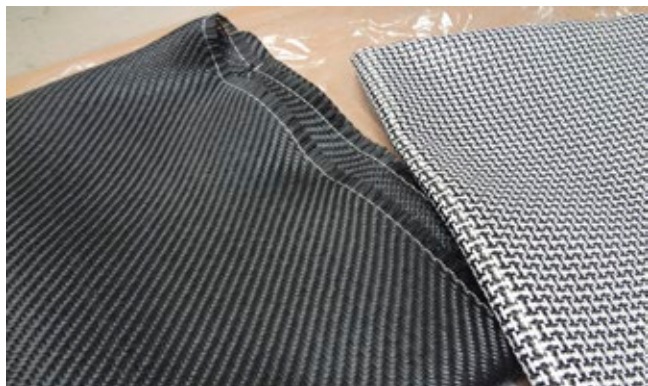
» Slika 1: Karbonska tkanina (levo) in hibridna tkanina karbon/innegra (desno)
