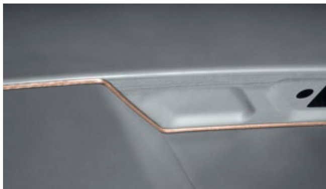
» Slika 1: Spajkan spoj na prtljažnih vratih Audija A3 2001 [1]
