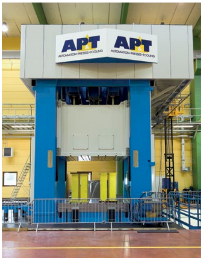
» Srce proizvodne linije, ki jo je AP&T dobavil družbi G-TEKT, je 1200-tonska stiskalnica ODEN.
