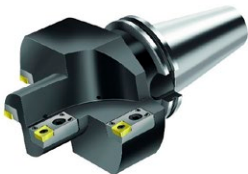
» Dvostopenjsko namensko orodje za izstruževanje za grobo obdelavo z Walterjevimi minidržali, notranjim hlajenjem in vrsto vpetja SK | Slika: Walter AG
