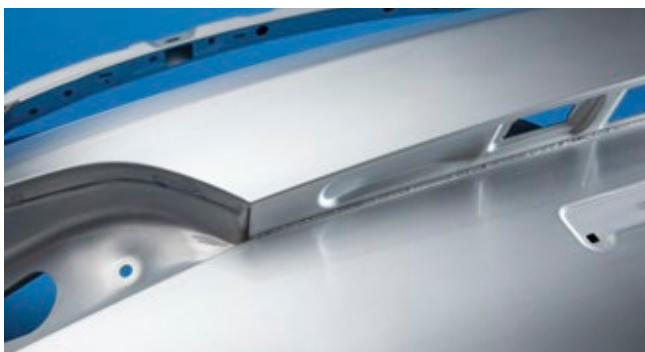
» Slika 4: Lasersko varjena aluminijasta vrata prtljažnika za Audi Q5
