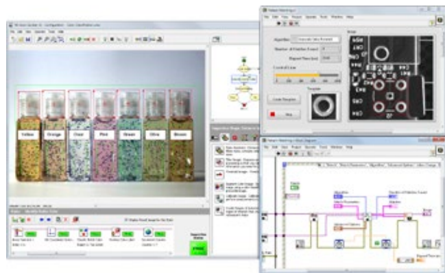
» Slika 3: (a) Konfiguracijski vmesnik za orodje Vision Builder for AI (b) Okna raziskovalca projekta, čelne plošče in blokovnega diagrama v okolju LabVIEW za aplikacijo s strojnim vidom
