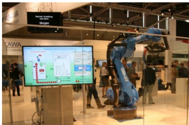
» Utrip s sejma AUTOMATICA 2012: Prikaz učinkovitosti in varčnosti robota z inteligentnim sistemom krmiljenja in povrnitve energije pri zaviranju
