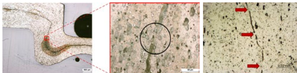
» Slika 1: Kovinski mikrokontakti, ki nastanejo med pločevinama pri masivnem hladnem preoblikovanju ob izdelavi okroglega spoja TOX®
