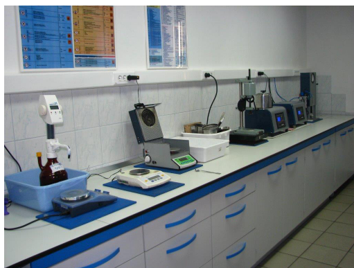
Laboratorij z napravami za ugotavljanje lastnosti formarskega peska.
