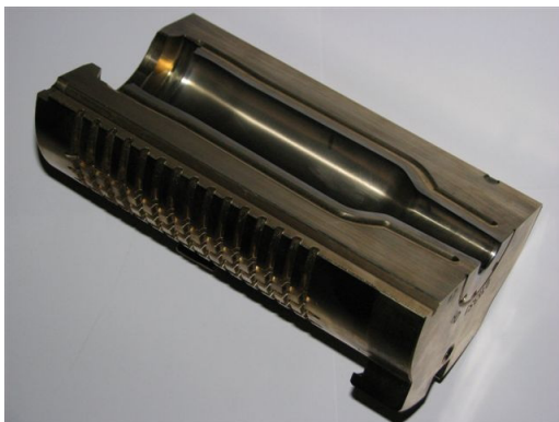
Izdelek za steklarsko industrijo: Naziv izdelka : Kalup Material: večkomponenten Al bron Uporaba: za izdelavo steklenic, specifičnost je v visokih zahtevah samega telesa steklenice.
