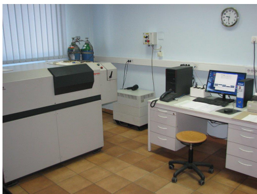
Spektrometer ARL 3460 za kemijske analize materiala. Spektrometer ARL 3460 za kemijske analize materiala.
