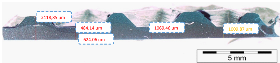
Slika 6. Meritve debeline vezi na vzorcu 2/6
