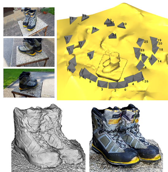
Slika 16: Nekaj primerov slik, uporabljenih pri rekonstrukciji (levo zgoraj), postavitev kamer (desno zgoraj) in rezultat goste rekonstrukcije gorskih čevljev (spodaj).
