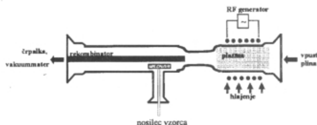
Slika 6: Razelektritvena posoda v primeru aktivacije v "postglowu"
