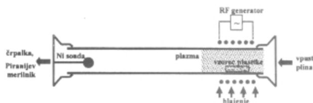
Slika 2: Razelektritvena posoda v primeru aktivacije v kisikovi plazmi
